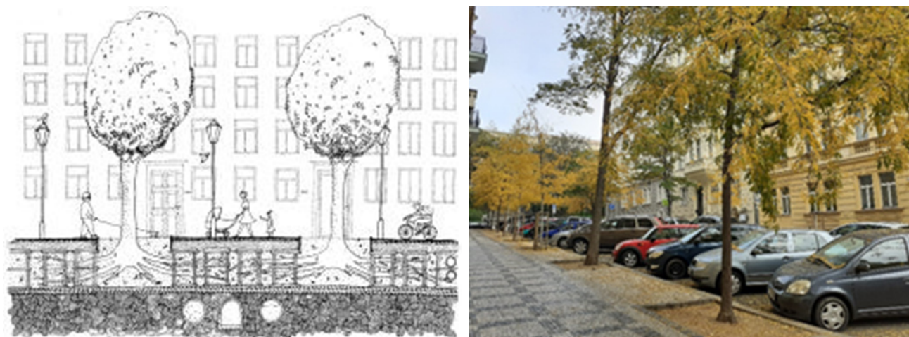
A gyökércella-rendszer elvi sémája és a prágai Budečská utcában felmért fasor. (Forrás: Prágai Városháza, Környezetvédelmi Osztály; Žofie Matějková rajza.)
